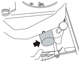
Bei Bedarf einen Filterabzieher verwenden.
