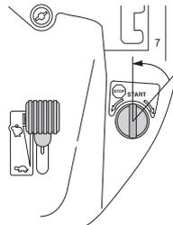
Den Motor 3-5 Minuten bei mittleren Drehzahlen (Halbgas) laufen lassen, bevor er stark belastet wird. Beim Mähen 3/4 bis Vollgas einsetzen.
