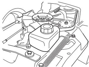
**FR 2218FA2** Bei Bedarf mit Motoröl SAE 10W/40 (Klasse SF-CC) auffüllen.
