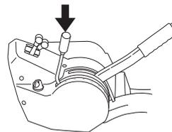
Um eine einheitliche Schnitthöhe zu erzielen, ist es wichtig, dass der Luftdruck in den beiden Vorderrädern 60 kPa/0,6 bar/8,5 PSI beträgt.
