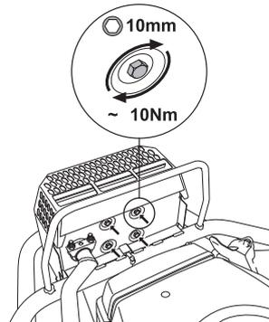
Temperaturschwankungen und Vibrationen können zu einer Reduzierung des Anzugsmoments der Schrauben führen. Zur Sicherstellung des korrekten Moments sind die Schrauben bei jedem Service zu kontrollieren. Das Anzugsmoment soll ca. 10 Nm betragen. Niemals ein Gerät mit defektem Schalldämpfer benutzen.
