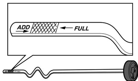
Das Öl wird durch die Öffnung nachgefüllt, in der der Messstab sitzt.
