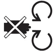
Rotierendes Schneidwerkzeug Niemals bei laufendem Motor die Hand oder den Fuß unter die Haube halten
