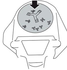
Luftleitweg auf der Unterseite der Motorhaube überprüfen, er muss sauber sein und darf nicht am Kühlluftinlass schaben.
