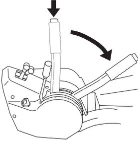
Der Hebel kann auch zur vorübergehenden Regelung der Mähhöhe, z. B. bei einer kleineren Erhöhung im Rasen, benutzt werden.
