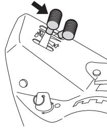
Wenn der Motor kalt ist, ist der Chokehebel bis zum Anschlag zurückzuziehen.
